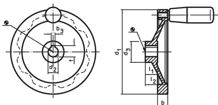
L'orientation de la rainure de clavette peut être différente de celle représentée sur le dessin.
