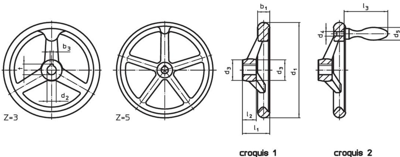
L'orientation de la rainure de clavette peut être différente de celle représentée sur le dessin.
