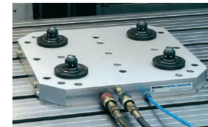
Table machine : Plateau de base avec 4 éléments de serrage
